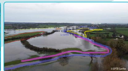
La cartographie réalisée par modélisation doit représenter au mieux les zones inondées en situation réelle.
