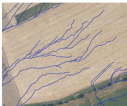
Représentation des axes de ruissellement à l'échelle d'une parcelle agricole (Source : EPTB Sarthe)
